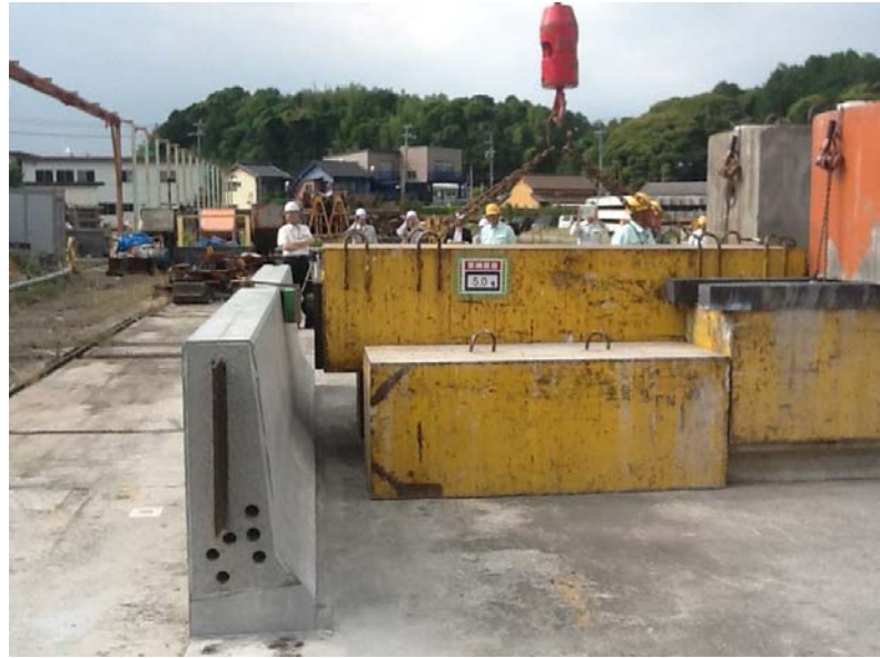
写真-参 5.1 重錘による簡易衝突試験の状況
