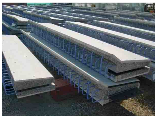
写真-4.6.2 平置き保管状況例
