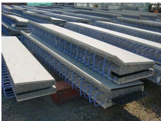
写真-4.9.1 平置き保管状況例
