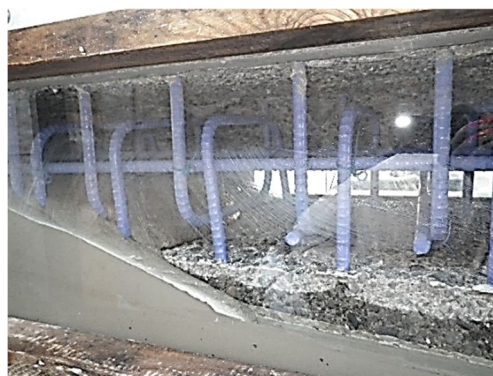
写真-7.6.2 透明型枠による充填確認状況例
