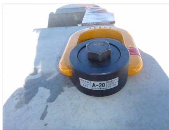
写真-5.2.2 天端吊りの治具の設置例
