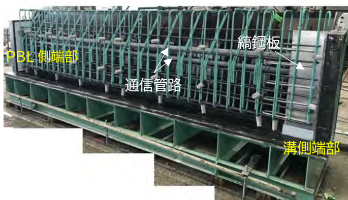
写真-4.5.1 バネ式通信管路2条配置例
