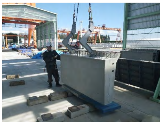
写真-4.8.1 製品の取出し状況例
