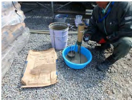
写真-5.3.2 コンシステンシー試験状況例
