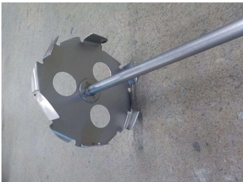
(b) ハンドミキサーのスクリューの拡大写真一例
