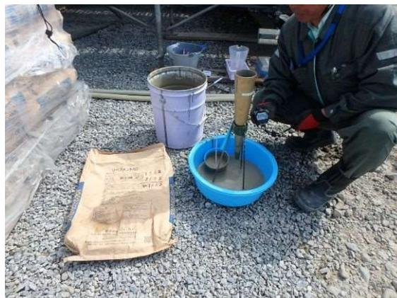
写真-2.2.2 コンシステンシー試験状況例
