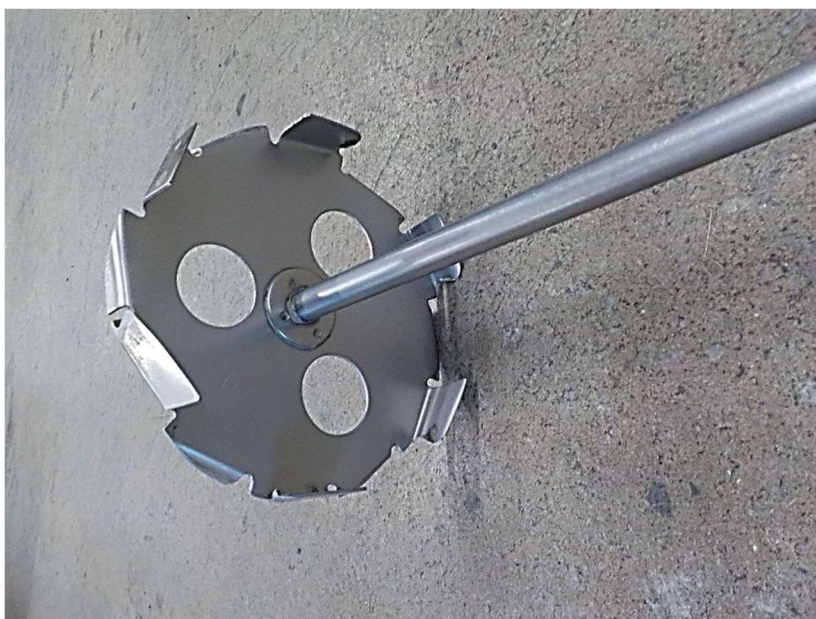
(b) ハンドミキサーのスクリューの拡大写真一例 写真-2.2.3 ハンドミキサー及び羽根の使用例
