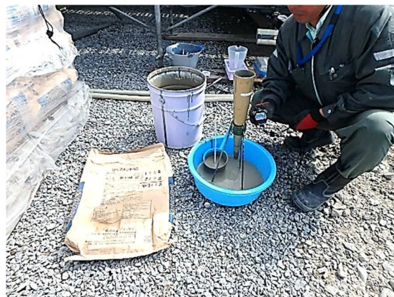
写真-2.2.2 コンシステンシー試験状況例
